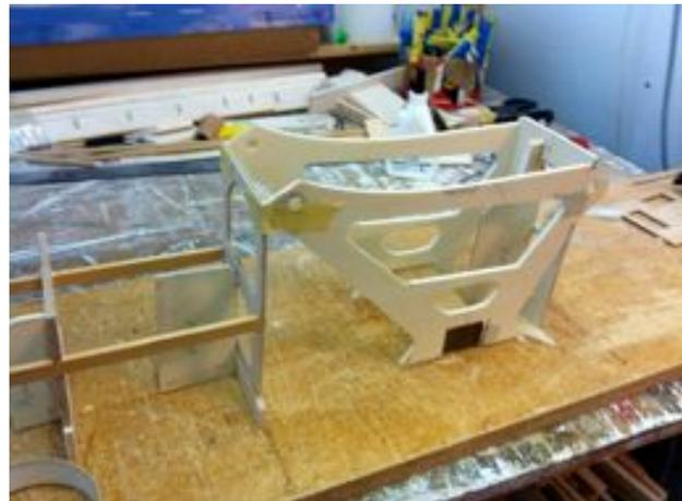
Die Zentrale Struktur des Rumpfes weicht schon deutlich von den Vorstellungen des Konstrukteurs ab, aber mir war es wichtig, dass die Kräfte des Fahrwerks gut abgeleitet werden.
