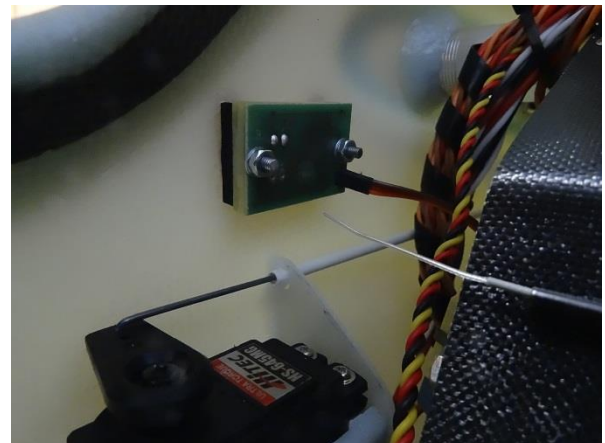
Oben: Die mitgelieferten Akkuhalter wurden modifiziert, und die MPX-Anschlussbuchsen wurden aus früheren Projekten abgeschaut.
