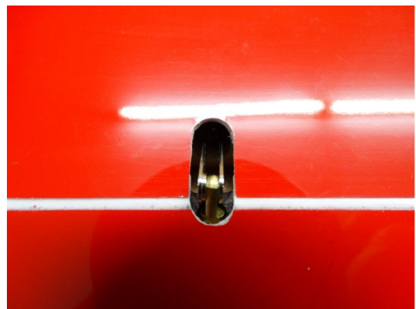
Konsole für die Augenschraube, Situation bei voll gesetzter Wölbklappe und in Neutralstellung.
