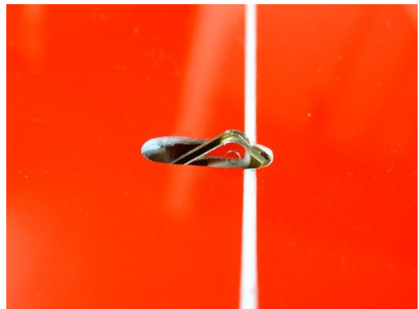
Gut zu erkennen: Im 45° Winkel angeschlagene Augenschrauben, das verbessert den Klappenausschlag. Nicht gut zu erkennen: Der Anlenkpunkt liegt exakt über dem Klappenscharnier.
