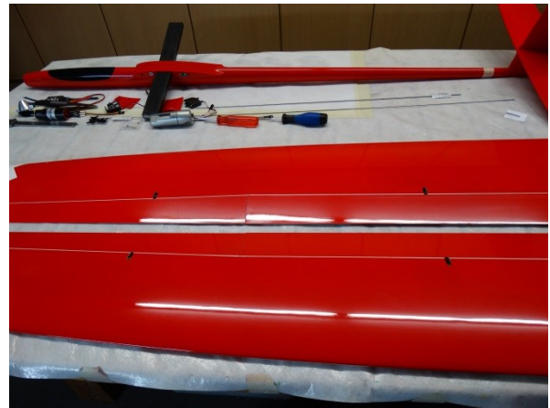
Fertig vorbereitetes Flächenpaar: Die Unterseite zeigt die Servorahmen, und die Oberseite zeigt die Aussparungen für die Anlenkungen
