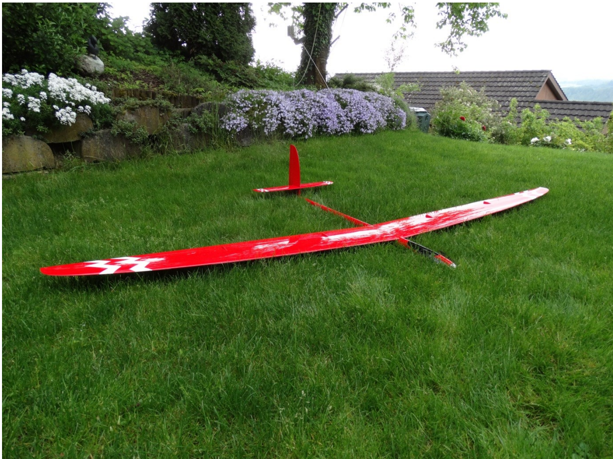
Zeus 3000-X von Launch Model in motorisierter Ausführung. 4-Klappen-Fläche in GFK mit Spannweite 2.96m
