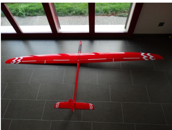
Voll-GFK Modell mit Schalenflächen in Rot und Weiss im Lieferzustand
